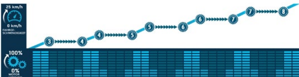
Herstellerausgabe Shimano: Schaltvorgänge Nexus Inter 5E Di2 Getriebe (oben) im Vergleich mit Nexus Inter 8 Getriebe (unten).
